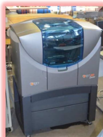
Impression 3D avec la nouvelle prototypeuse Connex 260 de l'ESE PAC
